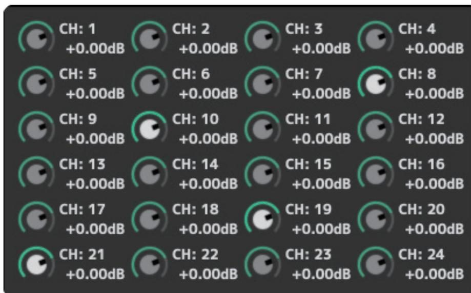
クロスポイント編集つまみでは、チャンネルが属しているクロスポイントの状態を編集できます。上図は入力チャンネルを選択している場合の画面です。画面には入力チャンネルから出力チャンネル 1~24 番に対応するクロスポイントのつまみが表示されています。
